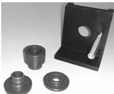
Support pour échantillons solides avec deux inserts spéciaux pour lentilles de contact SPECORD® 250 PLUS
